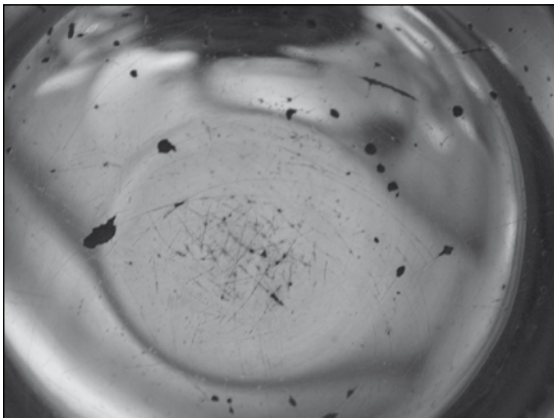
Blick in den alten Abendmahlskelch – das versilberte Messing ist von der Säure angegriffen. Foto: F.H.
